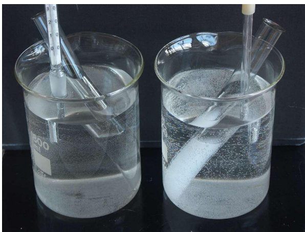
Obr. 1. Příklad fázové separace termosenzitivního polymeru; v obou zkumavkách je roztok poly( N -isopropylakrylamidu) ( 0,5 \text{ mg ml}^{-1} ) ve vodném chloridu sodném ( 0,15 \text{ mol l}^{-1} ), levá lázeň má teplotu místnosti ( 23 \text{ }^\circ\text{C} ), pravá lázeň má teplotu lidského těla ( 37 \text{ }^\circ\text{C} )
