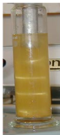
Obr. 5. Stojaté vlnění v kapalině
