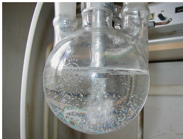
Obr. 1. Kavitace ve vodě
