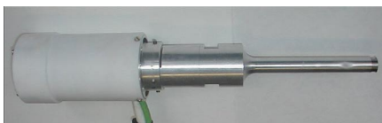
Obr. 10. Sonifikátor se stupňovitým vlnovodem
