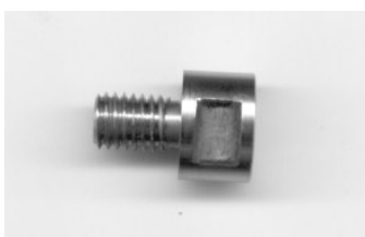
Obr. 9. Tip - konec vlnovodu (ultrazvukový nástroj)
