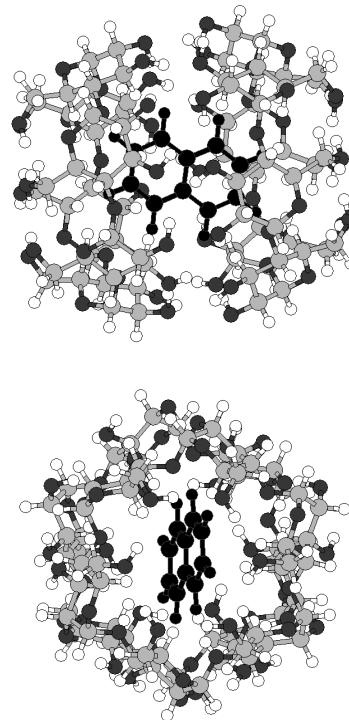
Obr. 7. Konformace inkluzního komplexu 1:2 tvořeného naftalenum (vyznačen černě) a \alpha -cyklodextrinem (atomy H jsou vyznačeny bíle, C světle šedě, O tmavě šedě) navržená na základě kvantově chemických výpočtů
